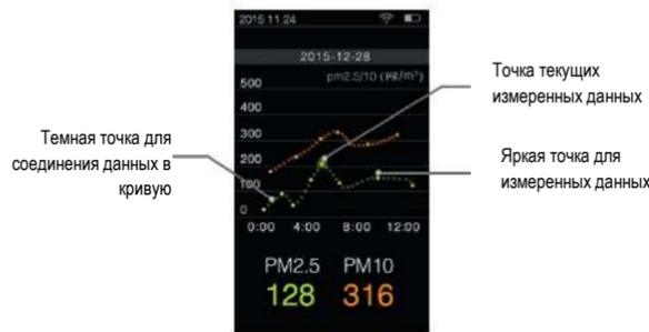
В окне измерений длительно нажмите кнопку Память/Вниз для открытия и закрытия окна «память». В окне отображается динамическая кривая измеренных данных. Для просмотра статических измеренных данных нажмите кнопку питания/Ввод. В окне статической памяти прибор отображает статическую кривую измеренных данных. Нажмите кнопку Вверх/Вниз для просмотра ретроспективных данных в пошаговом режиме.
