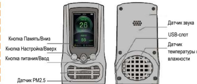
**Кнопка Настройка/Вверх:** длительное нажатие кнопки позволяет открыть/закрыть окно настроек: коротким нажатием включите режим измерения в окне измерений или включите режим в окне настройки/памяти.
